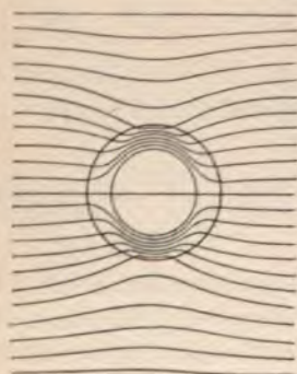
Abb. 119. Eiserner Hohlzylinder in einem homogenen Felde.
